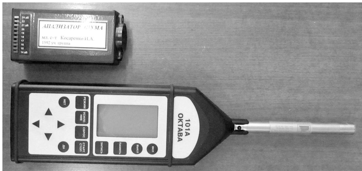
Рис. 4 — Сравнительное фото анализатора шума и шумомера "Октава"
