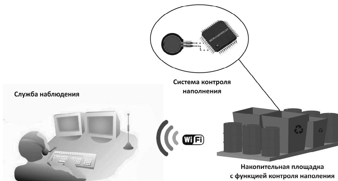
Рисунок 1 – Схема работы системы контроля наполняемости отходов
